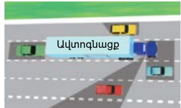
Այս պատկերի ստվերավորված հատվածները բեռնատարի վարորդի կույր գոտիներն են:
